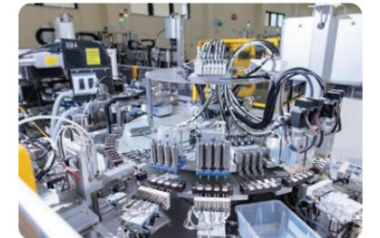
車載用サーモスタット検査工程の一例
